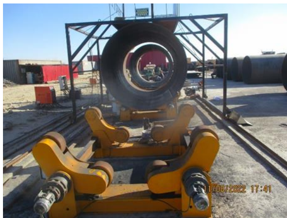
Изготовление напорных труб в цехе на площадке (АБИСРП 01)
